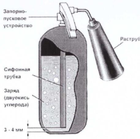
**ПРИНЦИП ДЕЙСТВИЯ:** При открывании запорно-пускового устройства  $\text{CO}_2$  по сифонной трубке поступает к растрюбу.  $\text{CO}_2$  из сжиженного состояния переходит в твердое (снегообразное). Температура резко понижается (до  $-70^\circ\text{C}$ ). Углекислота, попадая на горящее вещество, изолирует его от кислорода.
